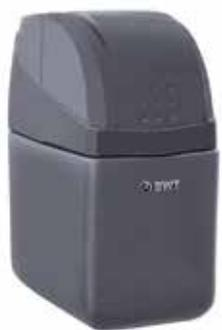
für **Geschirrspüler**, schützt Maschinen optimal vor Verkalkung, digitales Steuerungssystem, Timer und Kapazitätssteuerung möglich, vollautomatisch und einfach zu bedienen, hohe Leistung und geringer Salzverbrauch durch proportionale Besalzung, Drehventil für hohe Betriebssicherheit, Wassertemperatur min 5°C bis max 30°C, Nenndurchfluss 1.440L/h (nach EN14743)
